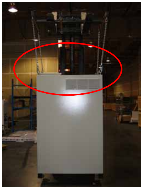
Abbildung 3-3 Lage der Ringschrauben – Sicht von oben
