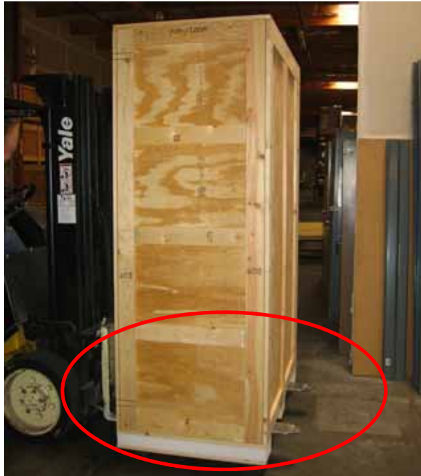
Abbildung 3-1 Hebepunkte für den Gabelstapler - Palettenunterseite
