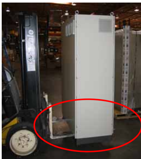
Abbildung 3-2 Hebepunkte für den Gabelstapler – Geräteunterseite
