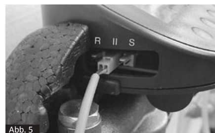
PT-DA / PT-DB: collegamenti sul lato sinistro del display: Linea di segnale (R), sensore di conducibilità (II), linea di impulso (S)
