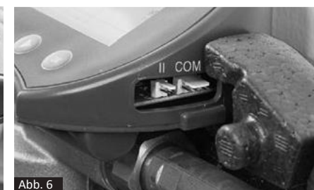
PT-DA / PT-DB: collegamenti a destra: sensore di conducibilità (II) Preparazione della comunicazione bidirezionale (COM)
